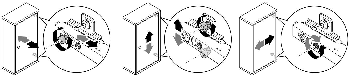
**32****Schublade ausrichten | Régler le tiroir | Regolare il cassetto | Adjusting the drawer | Nastavení zásuvky****Regulacja szuflady | Nastavenie zásuvky | Fiók beállítása | Çekmeceyi ayarlama**
